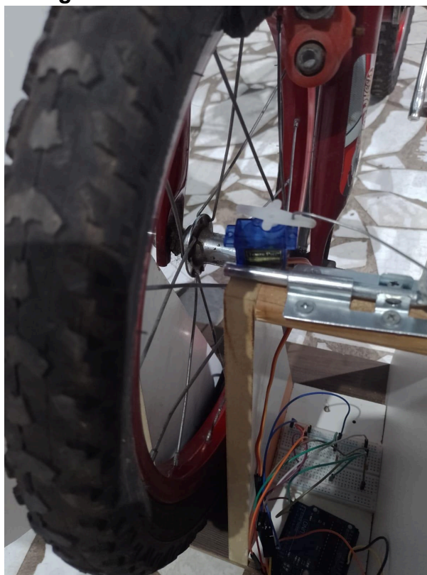
Figura 30 - Sistema de trava aberto
